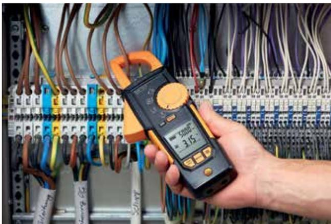
Medición de corriente en el armario de distribución.
