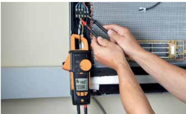
Medición de tensión en un equipo de aire acondicionado con **testo 770**.
